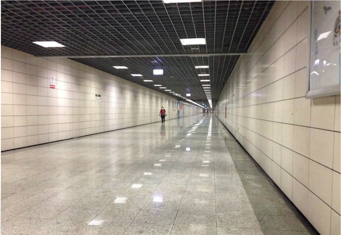
Fotoğraf 8. İstanbul Metrosu: Metro hatları arası bağlantı yolunun çok uzun olması, bu mesafeyi kat edebileceğiniz golf aracı gibi yöntemlerin olmaması, zemin kaplamasının kaygan olması ve ışık yansıtması, en az 30 metre aralıklarla dinlenme banklarının olmaması hareket kabiliyeti kısıtlı bireylerin ulaşım aracına varmasını güçleştirmektedir.
