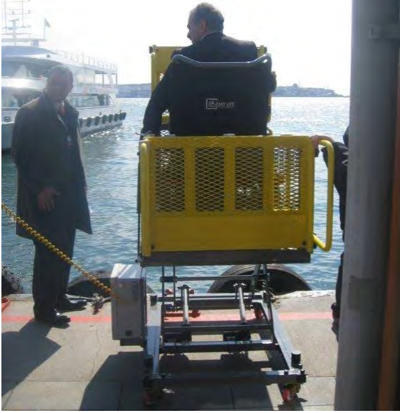
Fotoğraf 18. İstanbul Kabataş iskelesinde şehir için gemi seyahati için yapılan gemiye biniş asansörü.
