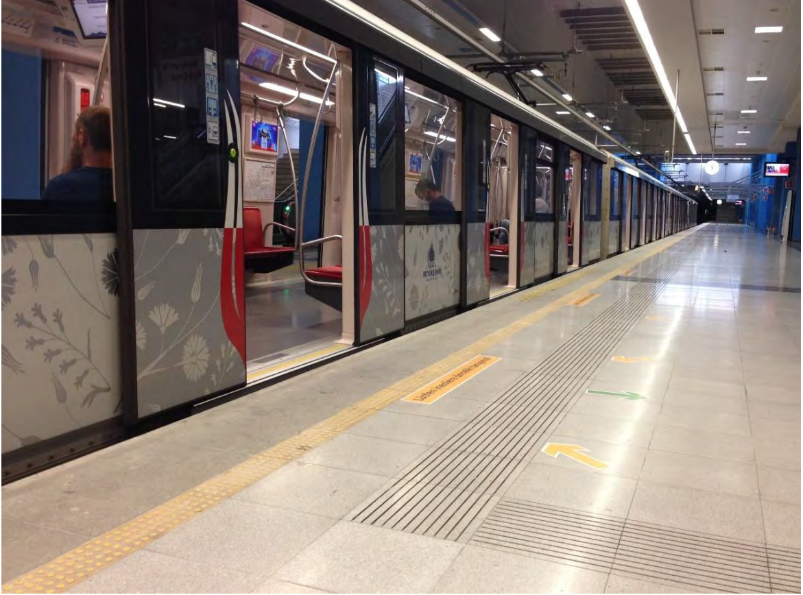
Fotoğraf 10. İstanbul Metrosu: Biniş peronu ile vagon arasındaki boşluk çok az ve eşit yükseklikte olması inişi ve binışı kolaylaştırmaktadır.
