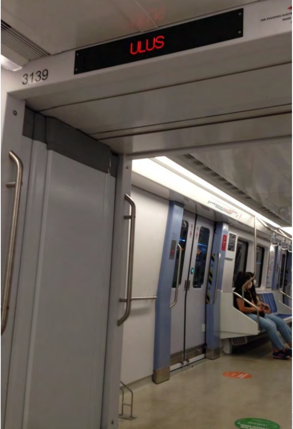
Fotoğraf 6. Ankara Metro'su: Tekerlekli sandalye, bebek arabası ve bisiklet için ayrılmış alan, bir sonraki istasyonu gösteren ışıklı pano.
